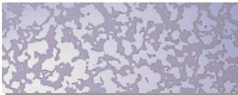
Głębokość wytrawiania jest sterowana funkcją czasu, w którym stal podlega działaniu kwasu.
